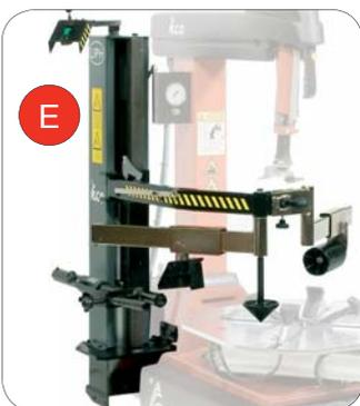
**IT DISPOSITIVO PNEUMATICO UNIVERSALE UPH & BPS (OPTIONAL):** Attrezzatura pneumatica ausiliaria UPH che assiste l'operatore durante il montaggio e lo smontaggio di ruote ribassate o particolarmente difficili come le Run-Flat. Tale dispositivo brevettato evita di dover utilizzare la leva durante lo smontaggio del secondo tallone. Generalmente fornito completo di secondo pressore flottante BPS.
