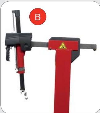
**IT BRACCIO OPERANTE:** A scelta con movimentazione manuale tramite molla rinforzata o con movimentazione pneumatica (versione P) a mezzo di un cilindro per ottenere un migliore livello di sicurezza e precisione. Il palo verticale è dotato di boccole coniche e sistemi di recupero giochi per facilitare le operazioni di manutenzione.
