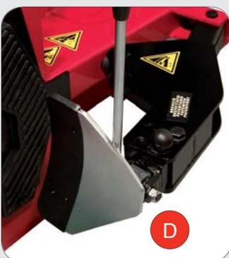
**IT SISTEMA DI STALLONATURA:** Braccio dotato di cilindro a doppio effetto ad alta efficienza ed equipaggiato con un meccanismo brevettato che permette di ottenere due diverse inclinazioni di lavoro tra paletta e ruota, migliorando così l'accuratezza dell'operazione di stallonatura. Anche l'appoggio ruota è regolabile in 2 posizioni di lavoro.
