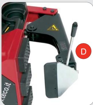
**IT** **SISTEMA DI STALLONATURA:** Braccio dotato di cilindro a doppio effetto ad alta efficienza ed equipaggiato con meccanismo auto-adattativo brevettato che ottimizza l'operazione di stallonatura mantenendo costantemente l'inclinazione ottimale di lavoro tra paletta e fianco del pneumatico. Anche l'appoggio ruota è regolabile in 2 posizioni di lavoro.
