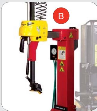
**IT** **PALO VERTICALE:** In configurazione extra-rigida, il palo è dotato di boccole coniche e triplo sistema di recupero giochi per facilitare le operazioni di manutenzione. La movimentazione pneumatica del braccio operante e il doppio sistema di bloccaggio completo di rullini di scorrimento del braccio orizzontale permettono di ottenere un migliore livello di precisione di lavoro.
