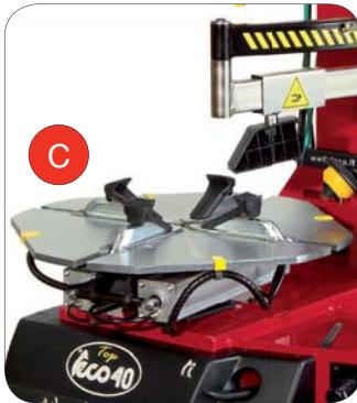
**IT** **PIATTO AUTOCENTRANTE:** Sistema con capacità di serraggio esterno da 11" a 24" per la **TECO 40 TOP** e da 11" a 26" per la **TECO 42 TOP** (con AR10 forniti standard). La speciale geometria del gruppo di serraggio griffe dotato di bielle curve permette di mantenere costante la forza di bloccaggio al variare del diametro del cerchio mentre il raccordo girevole in acciaio concorre a rinforzare tutta la struttura della macchina.
