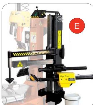
**IT** **DISPOSITIVO AUSILIARIO AUTOMATICO TPH:** Attrezzatura pneumatica ausiliaria TPH che assiste l'operatore durante il montaggio e lo smontaggio di ruote ribassate o particolarmente difficili come le Run-Flat. Dotato di utensile alza-tallone brevettato a posizionamento automatico che permette all'utensile Lever-Less di operare su qualsiasi pneumatico presente sui mercati internazionali.
