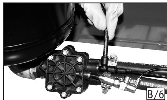
**7-** Den im Bausatz mitgelieferten T-förmigen Anschluss (**2, Abb. B/5**) am zuvor durchgeschnittenen Schlauch anbringen.
