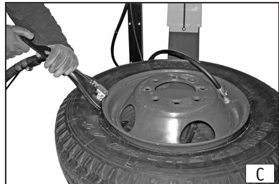
6- El chorro de aire desarrolla en el interior del neumático una serie de fuerzas que permiten obtener su entalonadura. Continuar el inflado de la manera anteriormente indicada.
