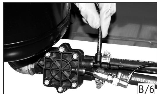
**9-** Enlever le bouchon en plastique (**1, Fig. B/3**) derrière la carcasse, puis faire sortir de ce trou le tube que l'on vient d'installer.
