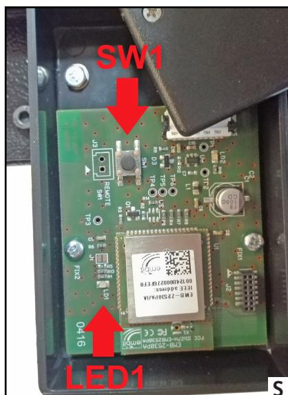
**1)** Déposer le couvercle du module radio du transmetteur en dévissant la vis (fig. P) pour pouvoir accéder à la carte électronique.
