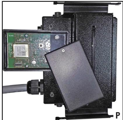
**2)** Togliere il coperchio del ricevitore svitando le 4 viti (**fig. Q**) per poter accedere alla scheda elettronica (**fig. R**).
