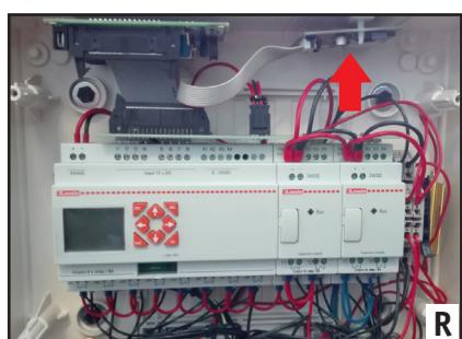
3) Einen Steuerbefehl betätigen, sodass das Funkmodul des Senders mit Spannung beaufschlagt wird, dann die Taste SW1 so lange drücken, bis die LED LD1 (**Abb. S**) zu blinken beginnt.
