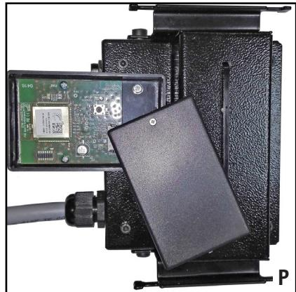
1) Den Deckel des Funkmoduls des Senders nach Lösen der Schraube (**Abb. P**) abnehmen, um Zugriff auf die elektronische Leiterplatte zu erhalten.
