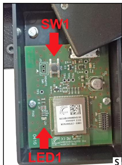
**4)** Mantener el presionado el pulsador SW1 del módulo radio del receptor hasta que el led LD1 deje de parpadear (**fig. T**). Si los dos led dejan de parpadear, la configuración ha finalizado.
