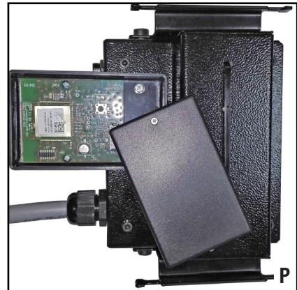
**1)** Déposer le couvercle du module radio du transmetteur en dévissant la vis (**fig. P**) pour pouvoir accéder à la carte électronique.
