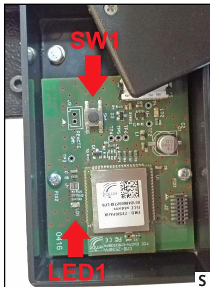
**1)** Togliere il coperchio del modulo radio del trasmettitore svitando la vite (**fig. P**) per poter accedere alla scheda elettronica.
