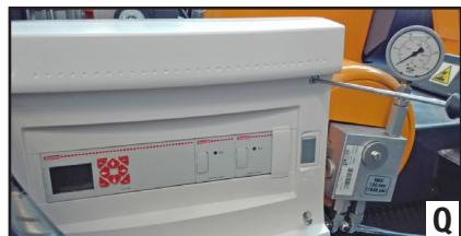
2) Den Deckel des Senders nach Lösen der 4 Schrauben (**Abb. Q**) abnehmen, um Zugriff auf die elektronische Leiterplatte (**Abb. R**) zu erhalten.
