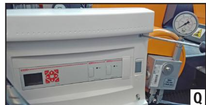
**2)** Quitar la tapa del receptor desatornillando los 4 tornillos (**fig. Q**) para poder acceder a la tarjeta electrónica (**fig. R**).
