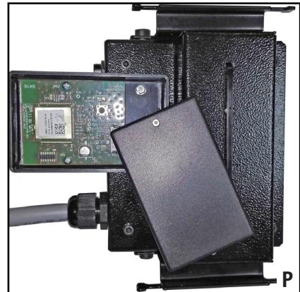
**1)** Quitar la tapa del módulo radio del transmisor desatornillando el tornillo (**fig. P**) para poder acceder a la tarjeta electrónica.
